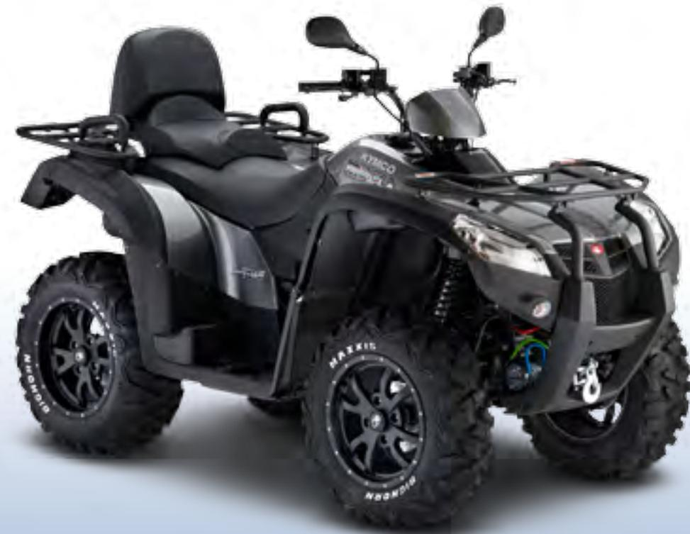
**Moteur :** Monocylindre 498,6 cm<sup>3</sup>, refroidissement liquide, injection, 4T
