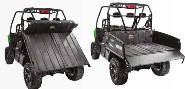
**CAISSON DE CHARGEMENT CONVERTIBLE** Le caisson de chargement à l'arrière du HDX de 142 x 108 cm offre une capacité de charge utile de 454 kg et 390 litre. Si vous transportez une charge plus large, celui-ci se transforme en plateforme en quelques minutes — assez large pour y placer une palette pleine grandeur. Pour couronner le tout, il bascule sans effort.
