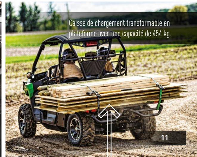
Caisse de chargement transformable en plateforme avec une capacité de 454 kg.
