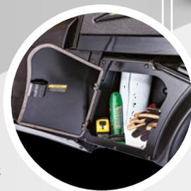
**MEILLEUR RANGEMENT FERMÉ DE L'INDUSTRIE** Le capot de type automobile s'ouvre de l'avant, ce qui facilite l'accès à l'énorme compartiment de rangement de 84,8 litres sous le capot, au radiateur et au réservoir de liquide de frein. En vous servant du levier à charnière, bloquez le capot en position verticale et manipulez vos objets à l'aide de vos deux mains. Vous manquez encore d'espace? Les compartiments devant les roues arrière s'en chargent, sans compter la spacieuse boîte à gants.
